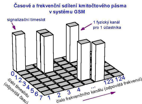
obr. 6: Časové a frekvenční sdílení kmitočtového pásma v systému GSM.
