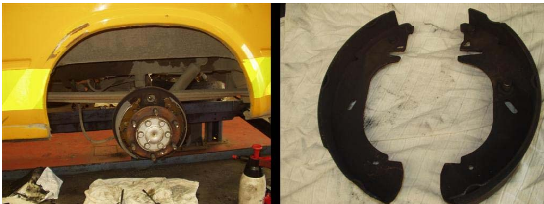
Obrázek 18.1: Brzdové čelisti nákladního vozu obsahující azbest.
