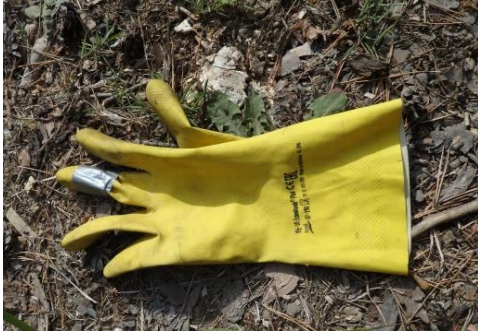
poškozené/protržené zalepené izolepou nepoužívat a zlikvidovat
