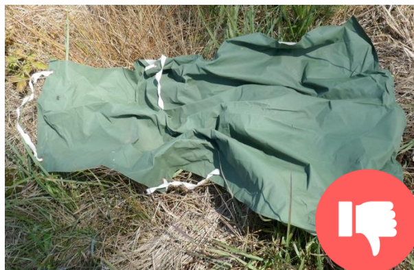
polyetylenové necertifikovaná, nezaručuje ochranu proti chemikáliím
