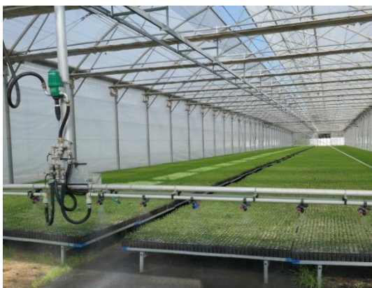
postřikovací/zálivkový most ve skleníku v lesní školce
