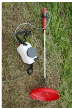
ruční UVL aplikátor (minimum úletů)
