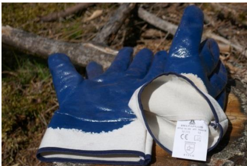
rukavice „zdánlivě“ odolné vůči chemikáliím, ve skutečnosti jen proti mechanickým rizikům – piktogram kladiva (a to ještě nižšího stupně)
