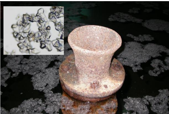
Obr. 3-14. Uhličitan vápenatý vysrážený na hladině vodojemu s vodou z podzemního zdroje.
