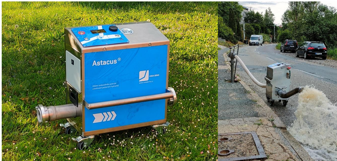
Obr. 7-6. Technologie pro čištění vodovodního potrubí, testování požárních hydrantů a měření teploty vody v potrubí (Ručka, 2024). Foto: Jan Ručka, VUT Brno.
