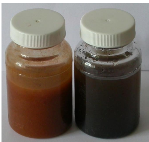
Obr. 3-11. Vlevo vzorkovnice se železitými sraženinami a korozními produkty, vpravo se sraženinami manganu.
