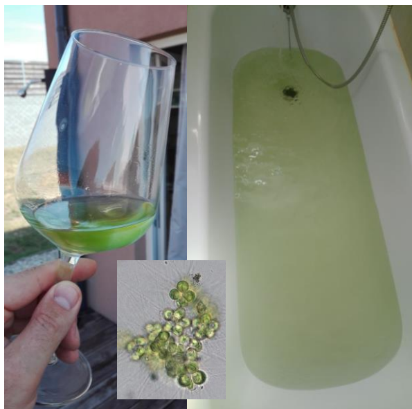
Obr. 3-13. Zelenou barvu vody způsobily zelené řasy, které se do pitné vody dostaly z propojení s vodou z potoka, kterou využíval jeden ze spotřebitelů na zalévání zahrady u rodinného domu.
