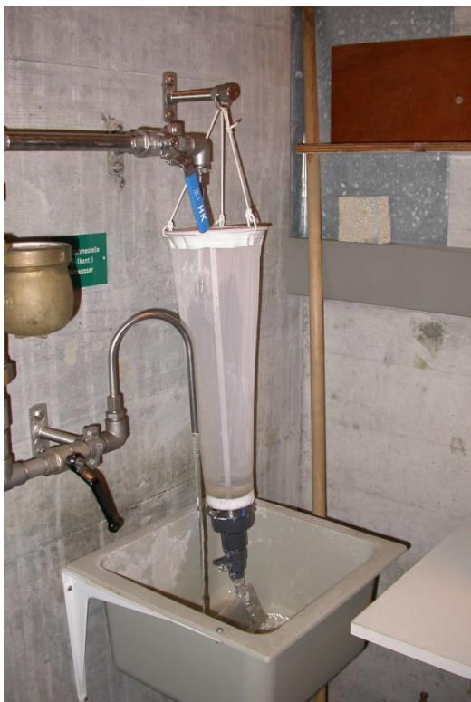
Obr. 3-6. Síťka, přes kterou na úpravně vody v Zürichu (Švýcarsko) kontinuálně protékala voda. Materiál zachycený v síťce byl v pravidelných intervalech odebírán a v laboratoři určován (foto: SZÚ).
