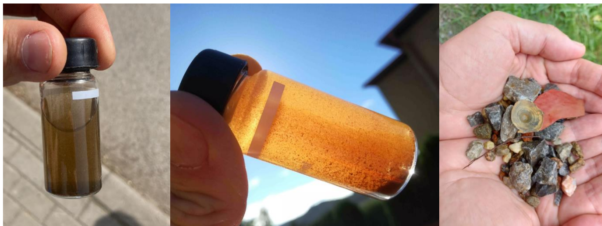
Obr. 7-1. Vzorky získané během řízeného proplachu potrubí. Černé sraženiny manganu (vlevo); oranžové produkty koroze kovových potrubí (uprostřed); kamínky, plastové špony z navrtávek, různorodé cizí předměty a části korodovaného materiálu kovových potrubí. Foto: Jan Ručka, VUT Brno.
