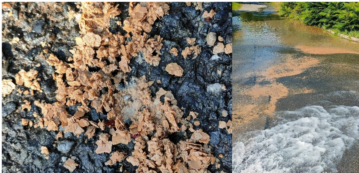
Obr. 7-3. Minerální sediment, vápenatá sraženina zbarvená železem vzniklá narušením chemické rovnováhy vody. Vzorek získaný řízeným proplachem potrubí. Foto: Jan Ručka, VUT Brno.
