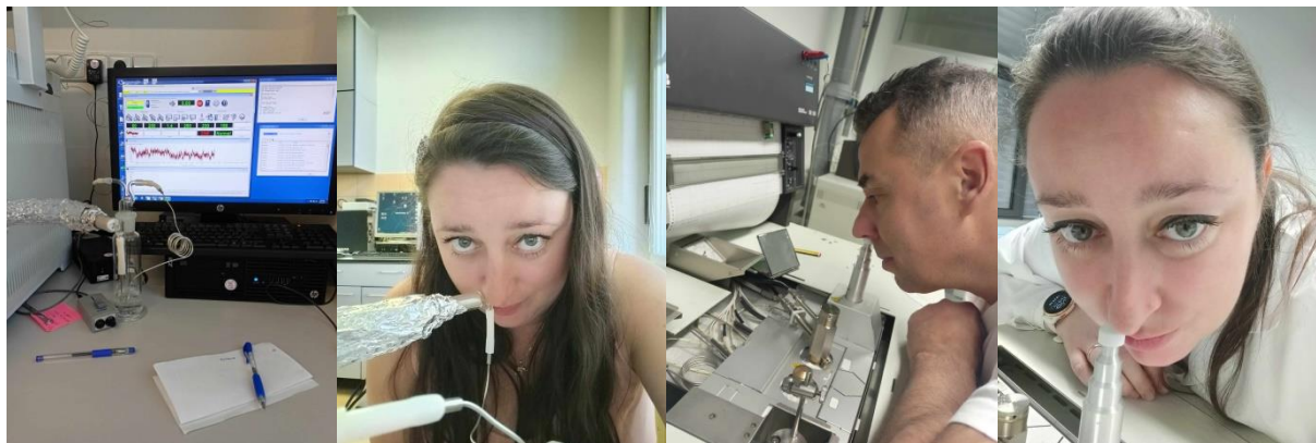
Obr. 3-1. Využití olfaktometrie-GC (GC-O) v praxi. Pracovníci SZÚ se snaží identifikovat látky, které způsobily pachové problémy v pitné vodě v Praze v létě a na podzim 2023 (foto: SZÚ).
